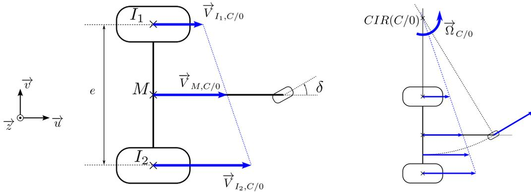
À tout instant, le centre instantané de rotation (CIR) du mouvement du châssis par rapport au sol définit le champ des vitesses en rotation. Notons que lorsque les deux moteurs tournent à la même vitesse, le CIR s'éloigne à l'infini et toutes les vitesses sont identiques, c'est une translation.
