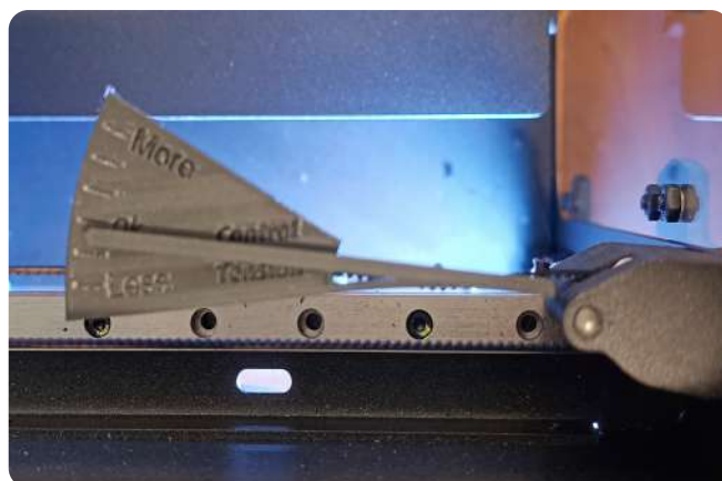
Retendre la courroie
