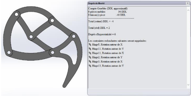
Figure 15. Les degrés de liberté d'une patte
