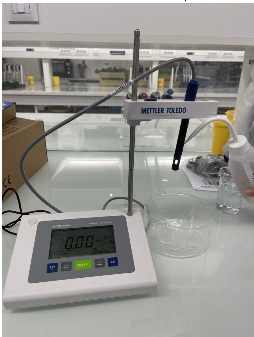
3. Plonger les électrodes dans la solution à tester
