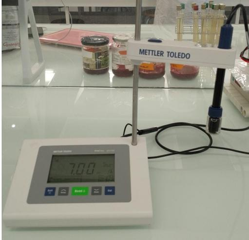
L'**étalonnage** vise à vérifier la précision du pH-mètre par
