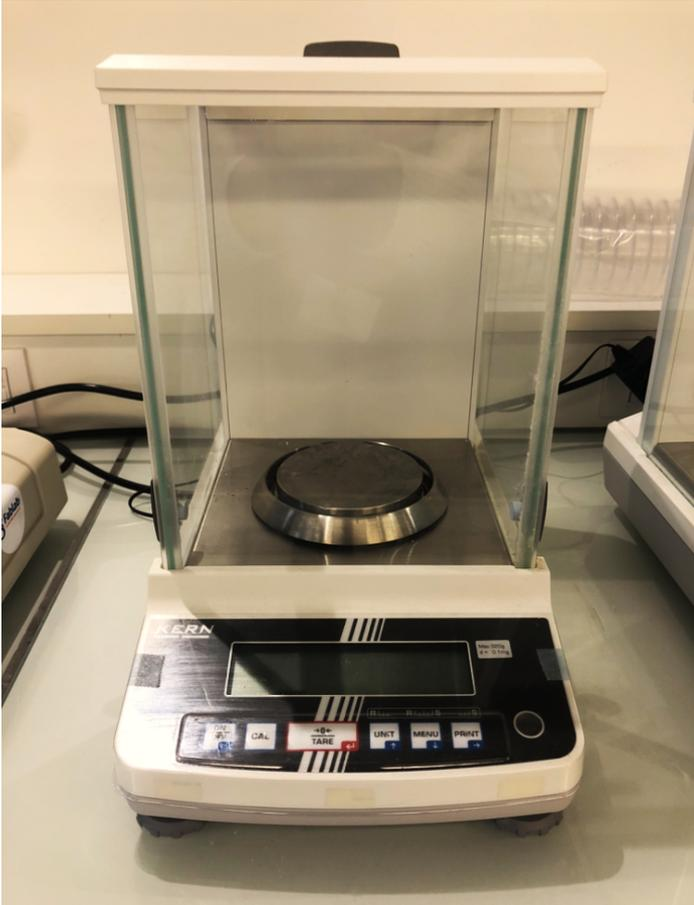
Comme son nom l'indique, cet appareil permet de mesurer des masses de façon précise à 0,0001mg près. La balance est composée d'une cloche s'ouvrant grâce à des portes coulissantes, sur les cotés et le haut de l'appareil. Sous la cloche, on peut trouver au centre le capteur de pesée. Enfin, en dehors de la cloche, on a l'écran ainsi que six touches pour notamment allumer/éteindre ou calibrer l'appareil. Cette balance permet de faire des mesures jusqu'à 320g.
