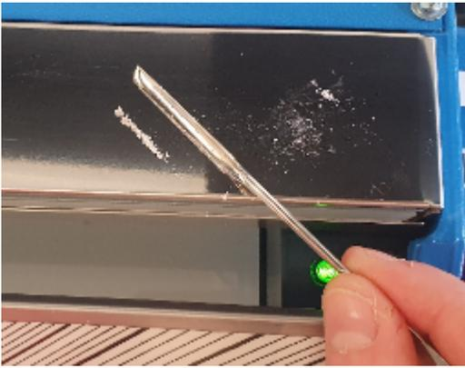
5. Lorsque l'étalon commence à fondre, s'arrêter et pointer la température correspondante avec l'aiguille (pas besoin de pointer avec l'aiguille s'il s'agit de déterminer la gamme de température de fusion)
