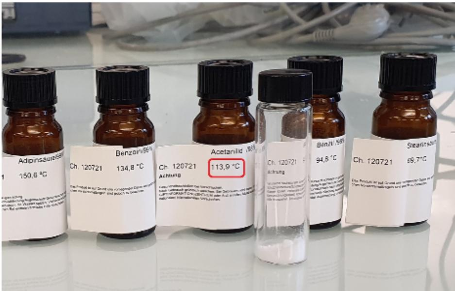
Dans ce cas-ci, le point de fusion de l'échantillon est attendu aux alentours de 120°C : on va donc choisir l'étalon à 113.9 °C.
