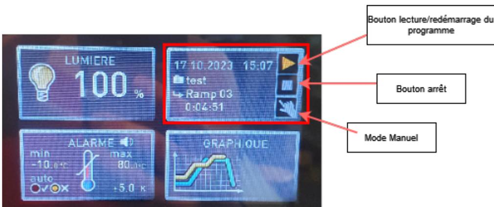
Il est possible de modifier les paramètres du phytotron sans arrêter les différentes manipulations en activant le mode manuel. Les différents menus de température, lumière et alarme deviennent alors accessibles et modifiables.
