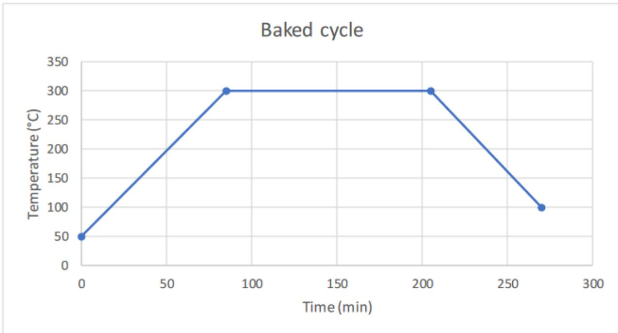
Le chauffage se fait de manière progressive avec des impulsions toutes les secondes à 80-90 A sous 20V. De plus, chaque impulsion génère des vibrations. A environ 100°C, la carcasse et les grilles du four sont accessibles au touché (froides).
