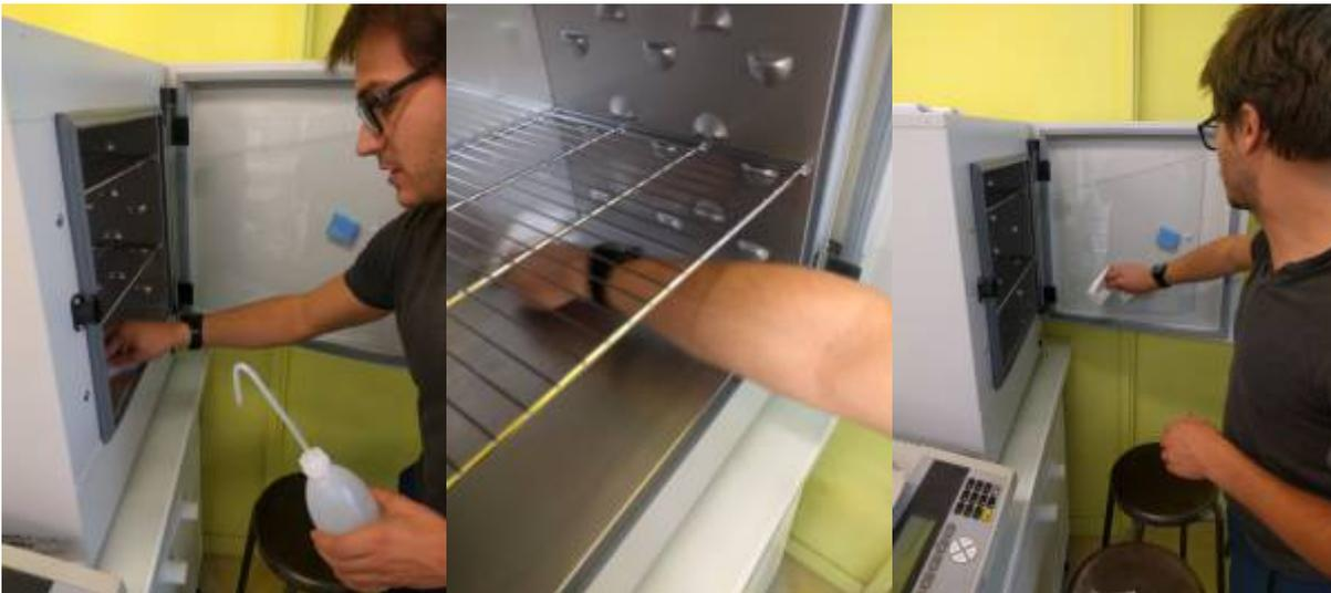
2. Appuyer sur l'interrupteur, la température interne actuelle s'affiche au bout de quelques secondes.
