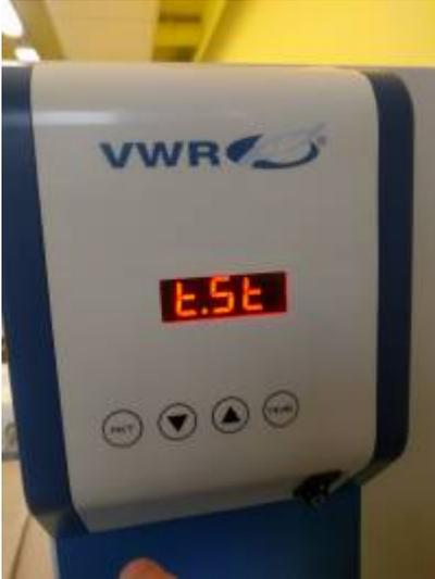
6. Appuyer sur "Time" pour lancer le timer , le timer n'attend pas que la température demandée soit atteinte, l'incubateur chauffe lentement il faut donc l'allumer longtemps à l'avance pour l'amener à la température d'utilisation et pouvoir utiliser le timer de manière effective.
