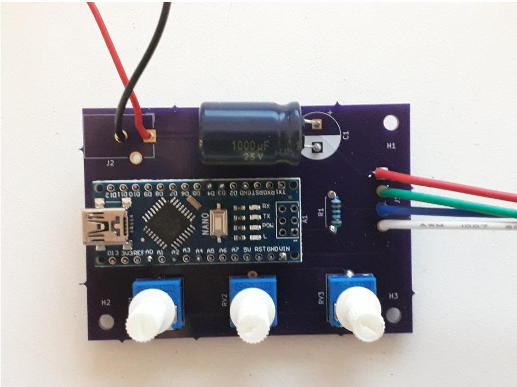
Remarque : les bandes LED usuelles ont 3 fils : GND, +5V et data. Ici j'ai utilisé une bande LED WS2813, qui possède 4 fils : GND, +5V et 2 fils data. Pour l'utiliser avec la bibliothèque Fastled de l'arduino, j'ai connecté les deux fils data ensemble.
