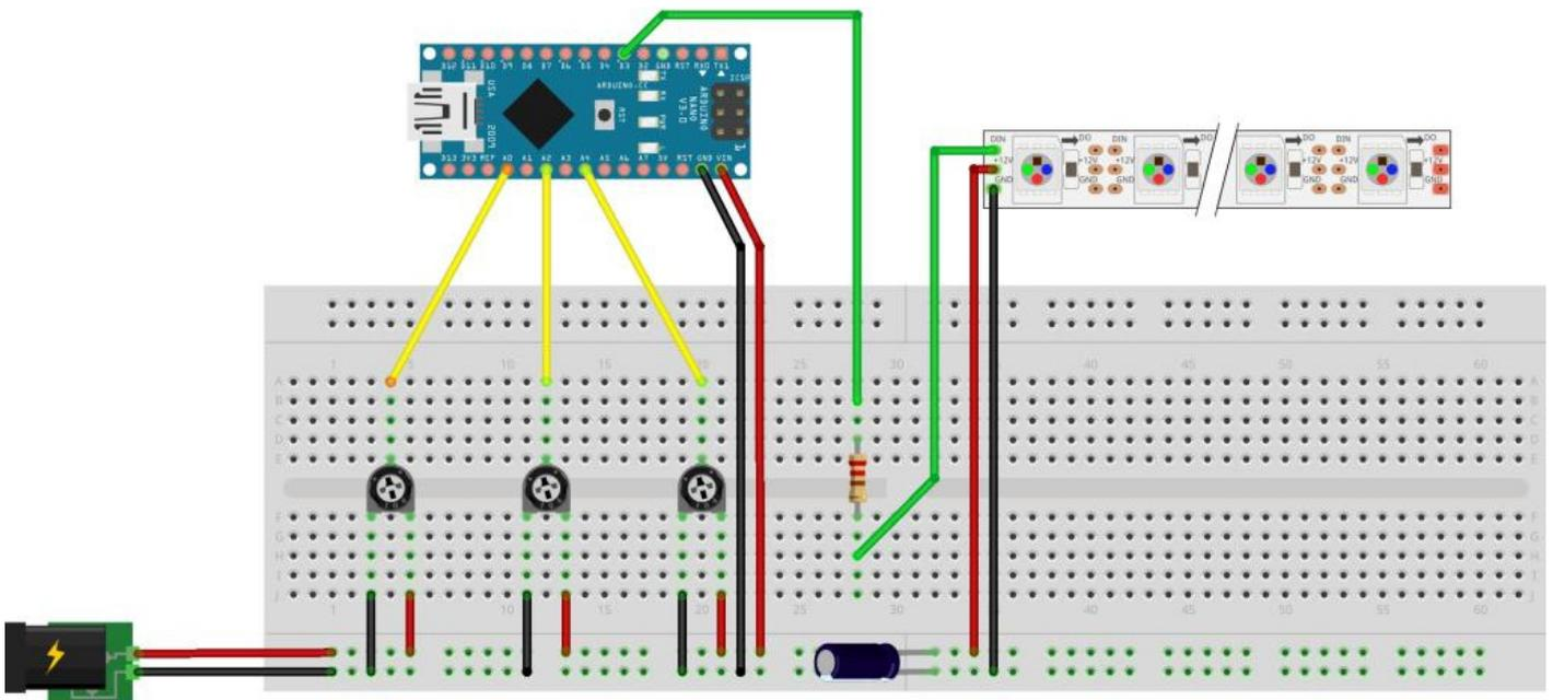
Les 3 potentiomètres servent de contrôle : leurs valeurs mesurées par l'arduino vont servir à contrôler la bande LED (par exemple sa couleur). Le condensateur sert de sécurité : lors de la variation d'un potentiomètre, ou de l'allumage des LEDs, il va absorber les chutes ou pics de tension.
