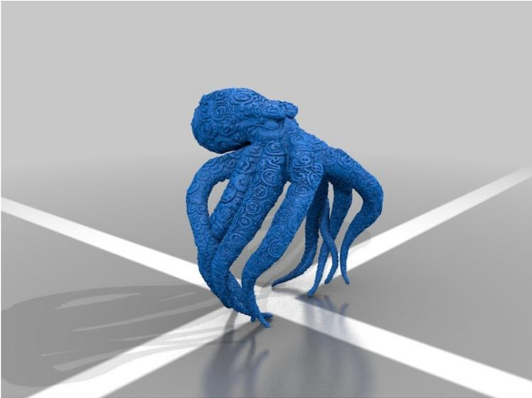
Pour la journée de Costumes et Déguisements, on a imprimé une bague qui se ressemble à une poulpe ! Pour que la pièce tient bien pendant l'impression, on a ajouté un radeau et des supports (automatiquement générés par le logiciel) et on a également utilisé nid d'abeilles à 30% de remplissage.
