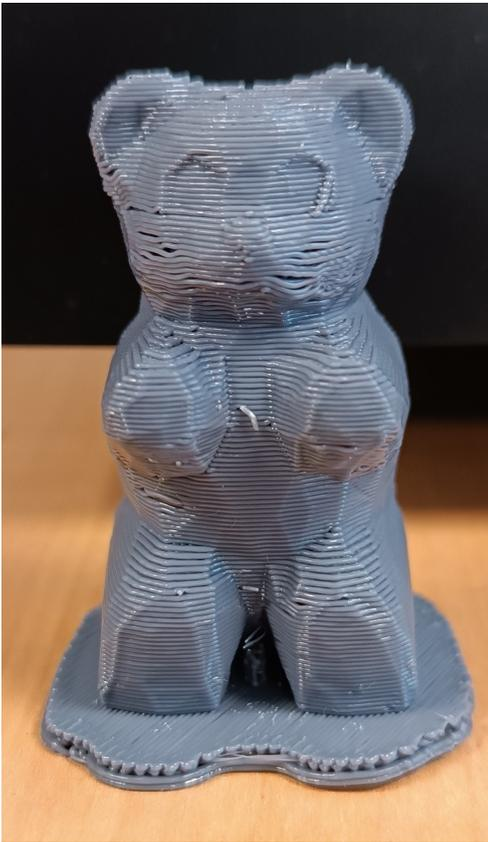
Une autre impression a été lancée avec une hauteur de couche de 0,3mm
