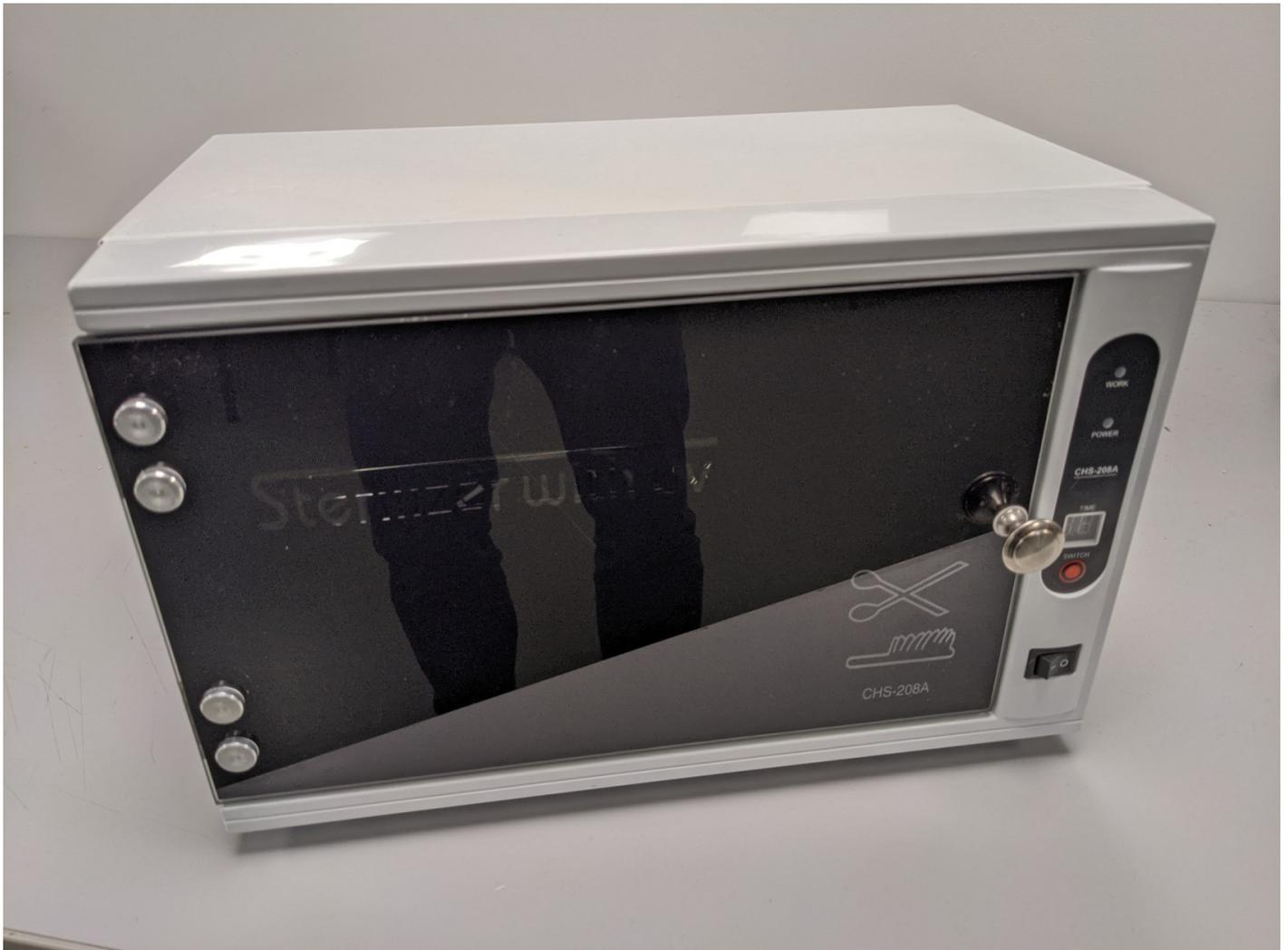
L'idée est donc de shunter le timer pour que le four reste allumé tant que l'interrupteur est enclenché.
