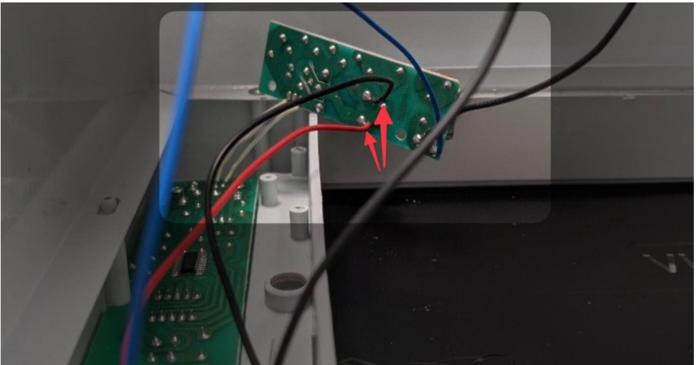
On dessoude donc les 2 câbles et on les ressoude ensemble, sans oublier d'utiliser une gaine thermorétractable pour protéger la connexion et prévenir les courts-circuits.
