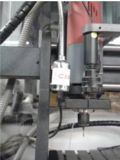
La LED permet d'un éclairage dans la cage pour pouvoir pointer l'outil facilement.
