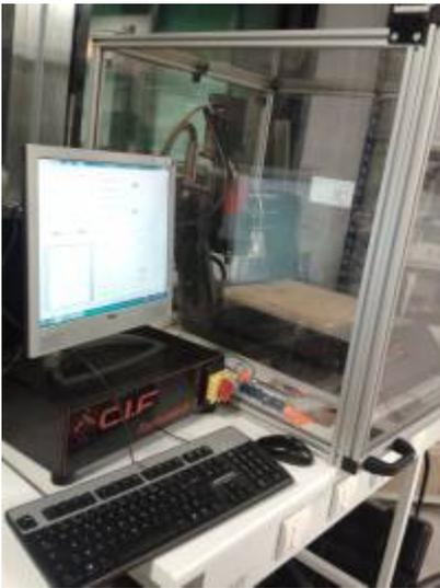
La Technodrill 2 de CIF est équipée d'un ordinateur sous Windows qui contient les logiciels Galaad et Percival. Cet ordinateur se trouve à gauche de la fraiseuse numérique.
