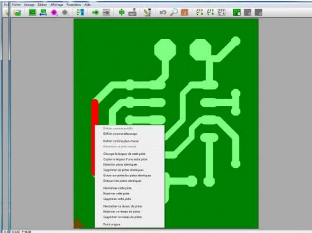
Les plans de masse devraient avoir été détectés automatiquement; si ce n'est pas le cas cela peut être corrigé via le menu «plans-masses» du menu «usinage».
