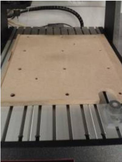
Quand vous ouvrez la cage, vous voyez une plaque en bois sur une plaque en plexiglas tout en bas. C'est ce que l'on appelle le plateau martyr, il est là pour créer un support sur lequel on va pouvoir fraiser. Il a été surfacé de manière à être parfaitement parallèle au plan X/Y de la machine. Ce surfacage a créé au fond un rebord parallèle à l'axe X de la machine, on s'en servira pour placer le PCB ou la pièce bien parallèle à l'axe X.
