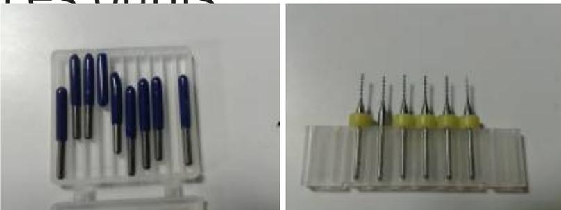
Il faut des outils avec une tige (ou queue) de 3,15mm (1/4 de pouce) de diamètre. Pour les PCB prendre des outils au carbure de tungstène; les outils au titane (aspect jaune) ne sont pas assez durs.
