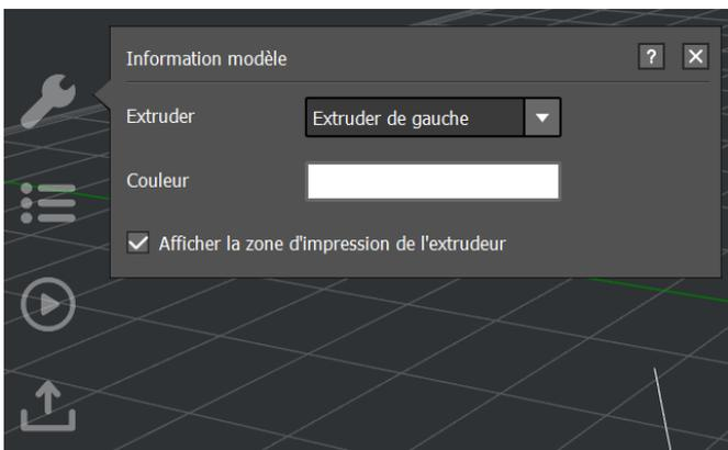
**5.** Allez dans la fenêtre "Préparer tranchage". Sélectionnez le bon modèle d'imprimante dans le menu déroulant "**Imprimante**" : *RAISE3D Pro2* ou *RAISE3D Pro2 Plus* selon celle qu'on va utiliser. Puis vérifiez que **le matériau de l'extrudeur de gauche** est bien celui que vous souhaitez imprimer. Ainsi pour le PLA il faut bien sélectionner les préréglages [*Raise3D*] *PLA 1.75mm (n templates)*.
