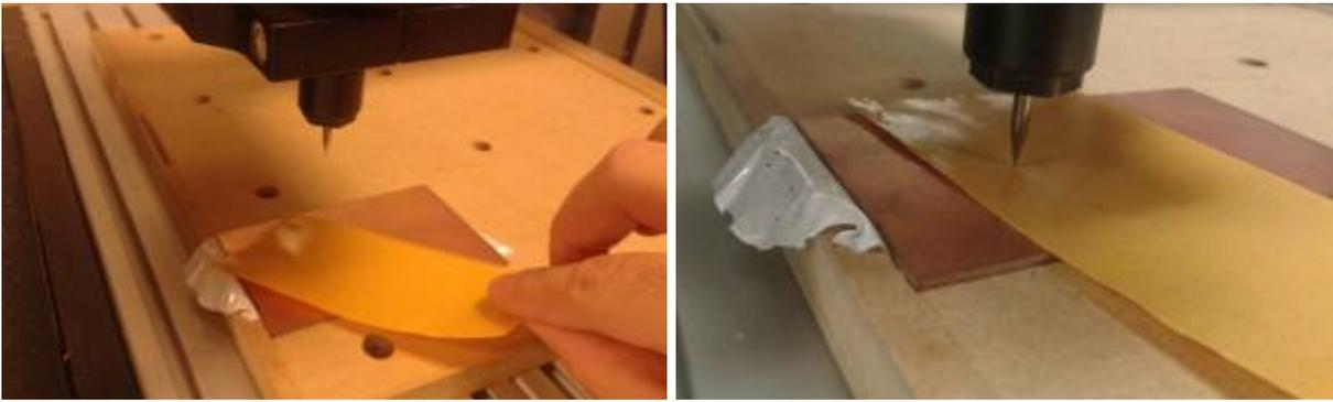
Il est bon de contrôler l'origine Z en différents points de la plaque, pour s'assurer qu'elle est bien parallèle au plan XY. Si ce n'est pas le cas, choisir le point le plus bas comme origine (pour être sûr que les outils descendent bien assez profond partout).
