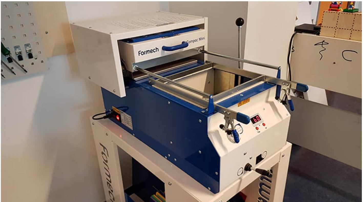
Le principe est simple : on chauffe une feuille de plastique et ensuite on fait le vide pour que le plastique prenne la forme de l'objet qui se trouve en dessous.
