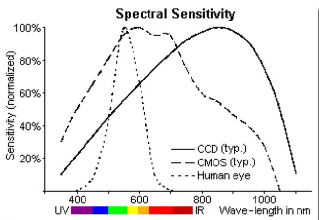
Ainsi, pour palier à ça, les constructeurs ajoutent des filtres à l'intérieur de la caméra, devant le capteur afin de couper les infrarouges et les UV. Ce sont ces filtres que l'on va essayer de retirer.
