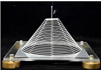
Dans le cadre de ma thèse, j'essaie de créer un programme permettant d'obtenir un motif de découpe à partir d'une forme 3D cible. Avec ce motif, je peux découper une feuille (de plastique) au cutter laser. Cette feuille, plate au repos se déploie lorsqu'on applique une force vers le haut ou vers le bas pour déployer dans le sens inverse.
