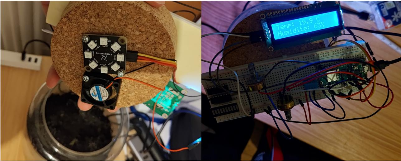
Le montage utilisant la plaquette led du kit et un [ventilateur](#). Afin de contrôler la luminosité des leds, j'utilise l'ADC du raspberry pi pico avec un potentiomètre. Pour contrôler le courant dans le ventilateur (max 0.18A) j'utilise également un potentiomètre comme une simple résistance variable. J'affiche la température et l'humidité dans mon appartement à l'aide de l'écran LCD et du DHT11.
