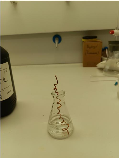
Ici, nous voulons tester pour deux fil de cuivre différents, nous avons donc besoin de deux solutions. On utilise une solution diluée donc la réaction prendra plus de temps. On la laisse pour voir ce que ça va donner
