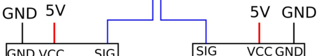
Il faut noté que le capteur à 4 pin cependant la pin non labéliser (entre VCC et SIG) ne sert a rien et donc nécessite aucune connexion.
