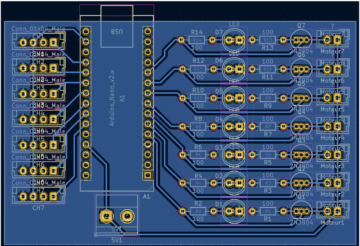
Nous utilisons 7 capteurs d'humidités et 7 pompes (le nombre max dispo au fablab).
