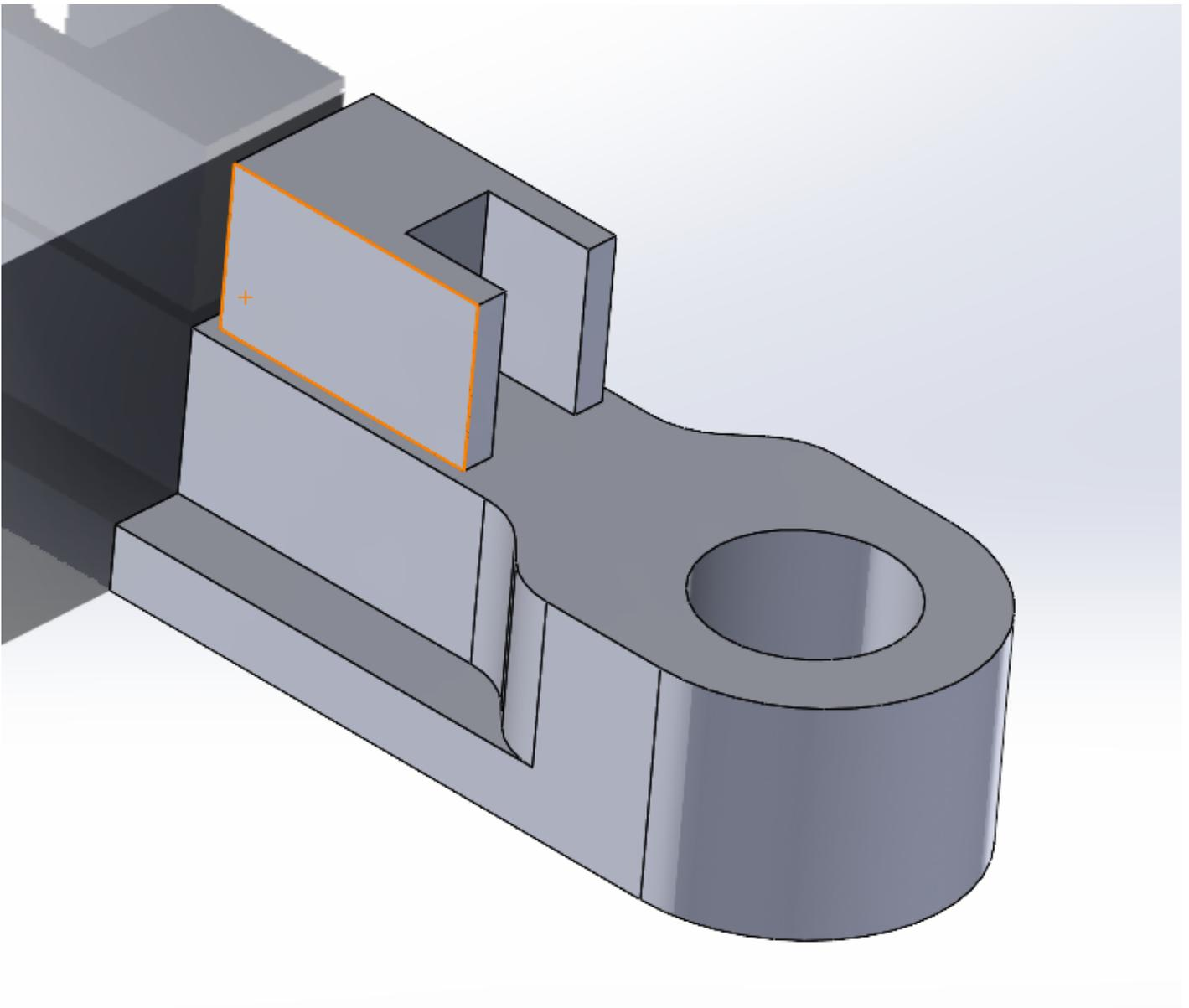
l'axe sera remplacé par un axe en acier, et la pièce sera en petg, pour résister à l'eau de la douche
