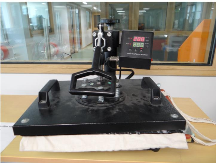
8. Retirez le textile et vérifiez que le flex a bien adhéré en décollant légèrement et soigneusement le plastique transparent. Si ce n'est pas le cas, vous pouvez remettre le tissu dans la presse encore quelques secondes.
