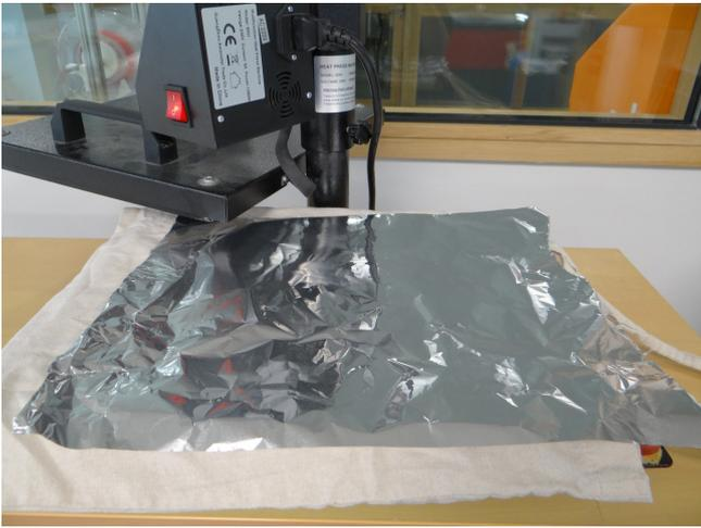
7. Abaissez le couvercle sur la feuille d'aluminium et laissez le temps nécessaire (cf tests au point 1). La presse du Fablab a un compte à rebours qui peut être réinitialisé et lancé à l'aide de la flèche vers le bas. Ici nous avons laissé 50 secondes de décompte à 200°C avant de retirer le tout.
