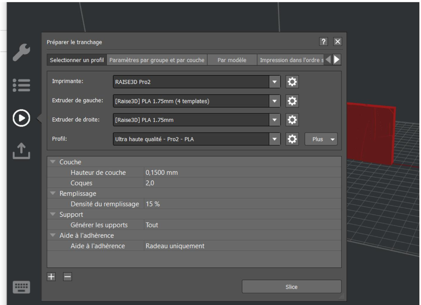
Utilisation des parametres suivant afin d'avoir une uniformisation des filaments donnant ainsi un rendu très propre pour cela on a aussi utilis  le filament de chez makershop3D "Marble" . Attention changer la temperature de buse et mettre 218 au lieu de 215
