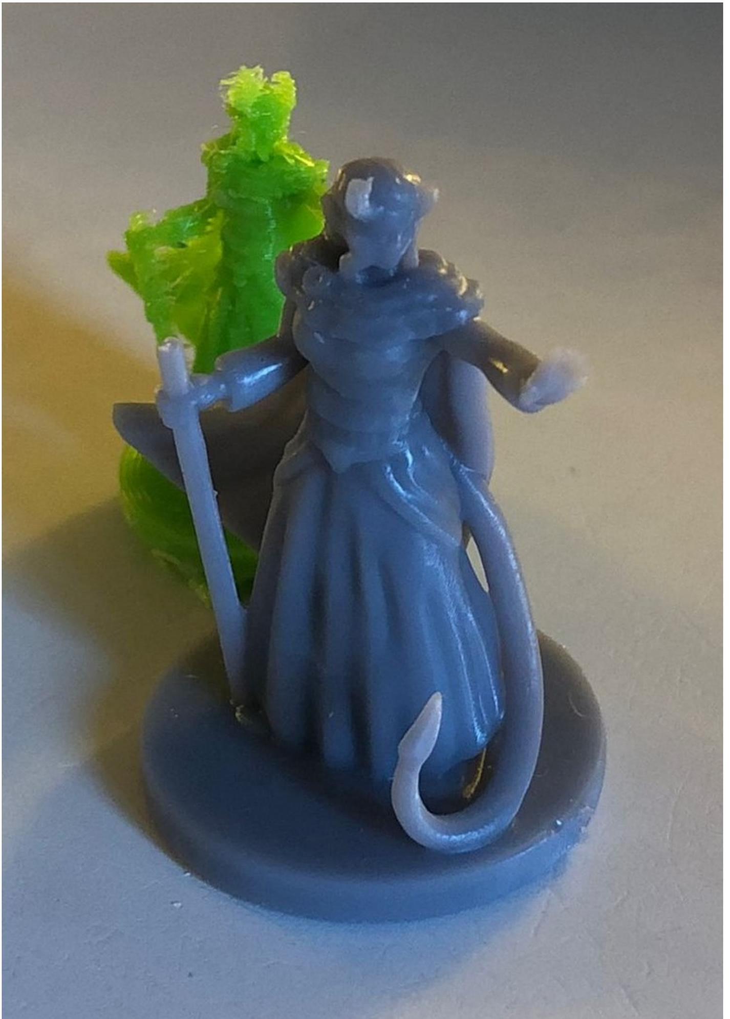
*Comparaison pour le même modèle entre l'impression plastique (vert) et résine (grise). La finition est plus fine avec la résine, même si on perd le choix de couleur du plastique.*
