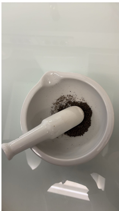
Figure 6 : Broyage des peaux de banane avec un mortier
