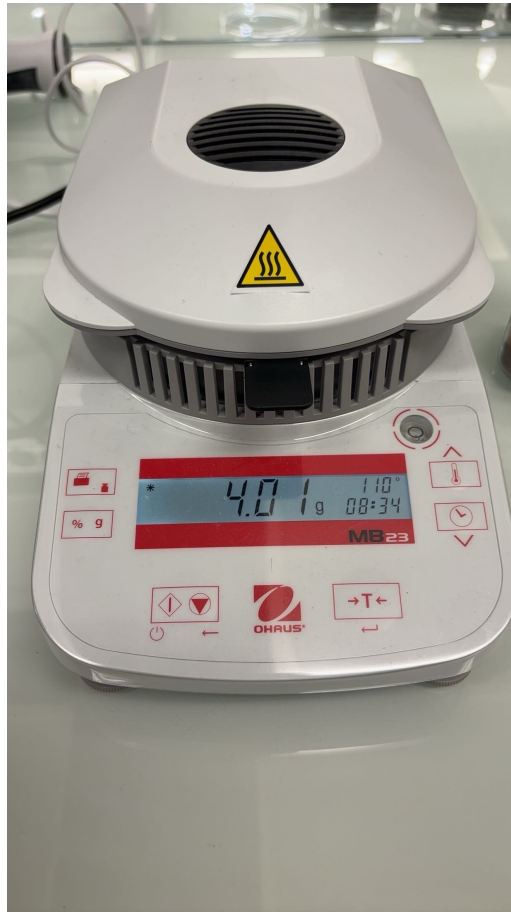
Figure 8 : Mesure du taux d'humidité de la poudre de banane
