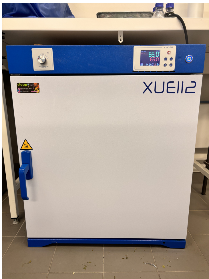
Figure 3 : Four XUE112 utilisé (65°C)
