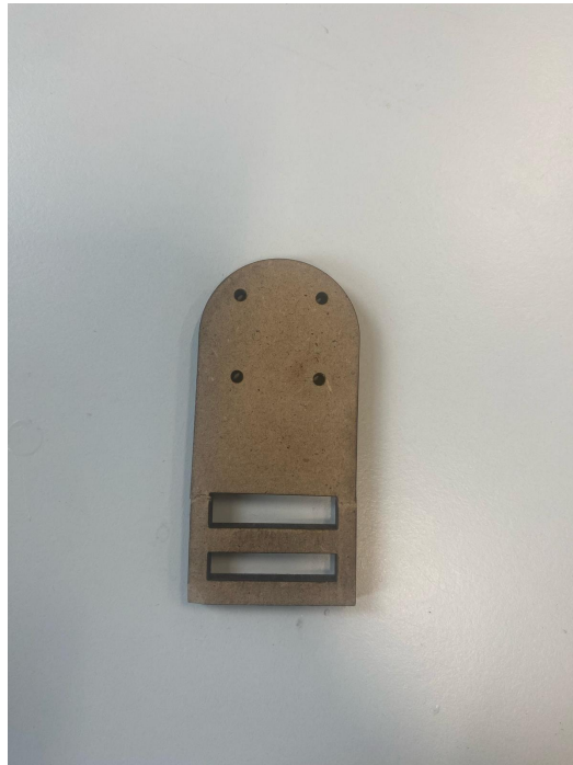
Support moteur avec trous moteurs + découpes rectangulaires
