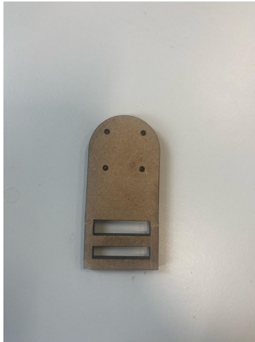
Support moteur avec trous moteurs + découpes rectangulaires
