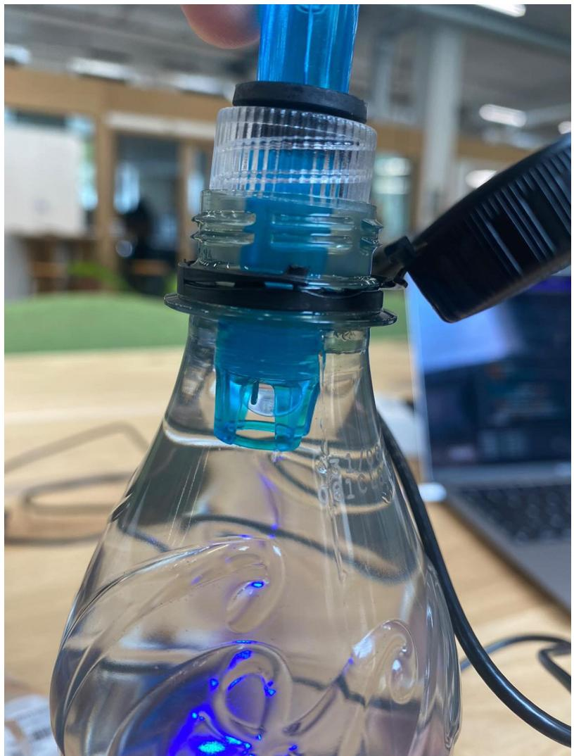
Comme les images ci-dessus l'indique, le code a fonctionner et la sonde est en capacité de prélever le pH d'un liquide. ( L'eau étant prélevée du robinet il est normal que le pH ne soit pas exactement équivalent à 7, mais qu'il s'en approche)
