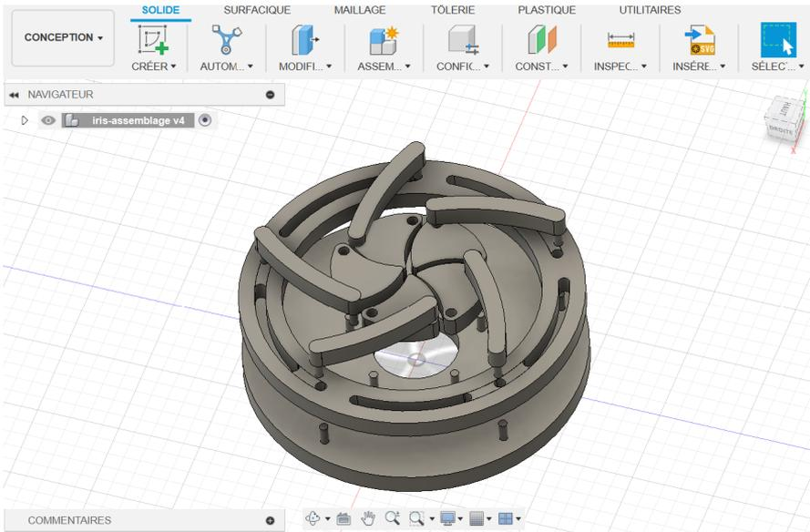
Afin d'assurer un bon assemblage des pièces, nous avons vérifié que la tailles des trous dans lesquels les pièces s'imbriquent soit supérieur à la taille nécessaire pour prendre en compte la marge d'erreur de l'imprimante 3D.
