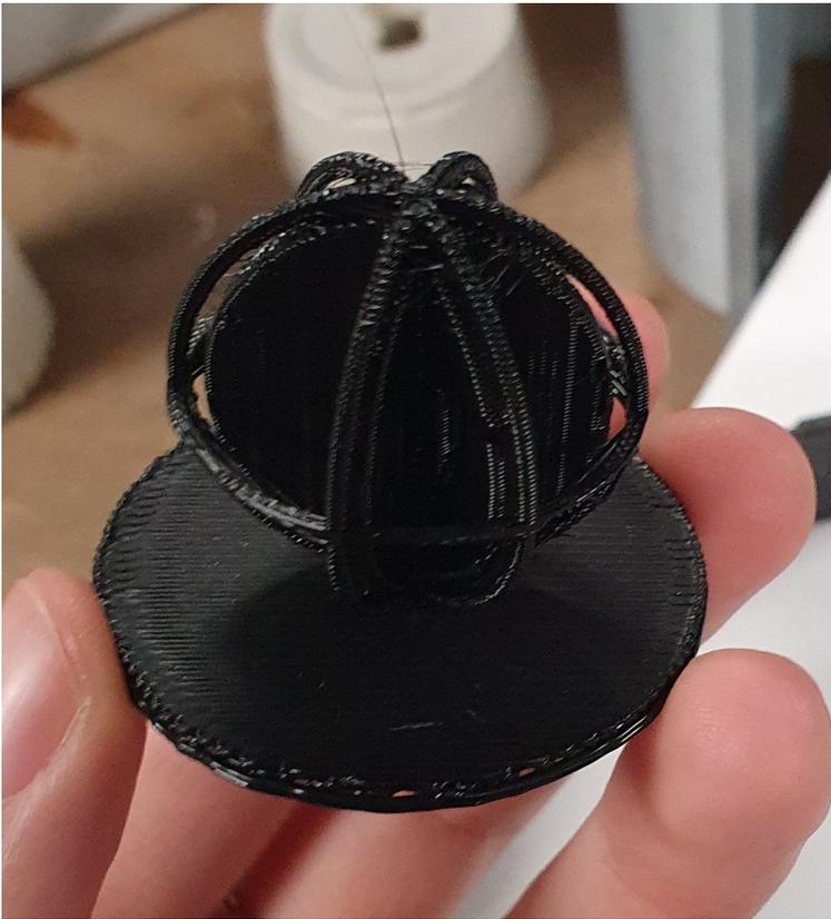
Cependant, je n'ai pas baissé les bras. J'ai décidé d'investir encore plus de plastique et d'énergie pour atteindre mon objectif ultime. En augmentant l'échelle à 7 cm et en ajustant les paramètres de densité (30% de remplissage, 1% de support), j'ai finalement réussi à obtenir l'objet tant désiré après une impression de 5 heures et 49 minutes:
