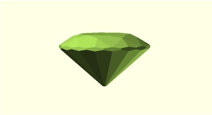
Sur IdeaMaker, j'ai choisi que la densité de remplissage sera de 10%. Vu que mon objet sera transparent je souhaite que à l'intérieur ça soit vide. A voir si cela à marcher à l'impression 3D ou s'il faut modifier. L'impression 3D a duré 2h30 avec un autre objet mis à côté pour l'impression, afin de gagner du temps et ne pas occuper plusieurs machines en même temps. J'ai décidé cette fois-ci d'utiliser du PLA transparent pour représenter au mieux un diamant.
