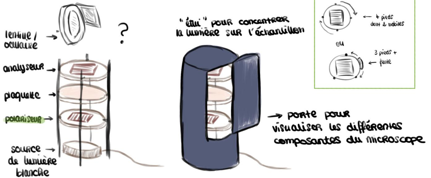
Dessin : prototype de notre microscope simplifié
