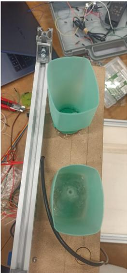
Ensuite, les récipients ont été solidement fixés sur la planche à l'aide de colle, reliés via des tuyaux en plastique aux électrovannes fixées avec des vis et des écrous.
