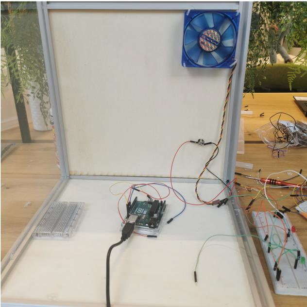
L'écran a été positionné en haut de l'enceinte, fixé solidement par des vis. Pour le capteur, nous l'avons placé à l'entrée de l'enceinte sur une breadboard collée à la contre-plaque. À côté, deux LED, une verte et une rouge, avec l'alarme ont été fixées sur une autre breadboard. Et au cœur de tous les composants, nous avons installé l'Arduino, le fixant avec des vis pour assurer sa connexion à tous les autres éléments.
