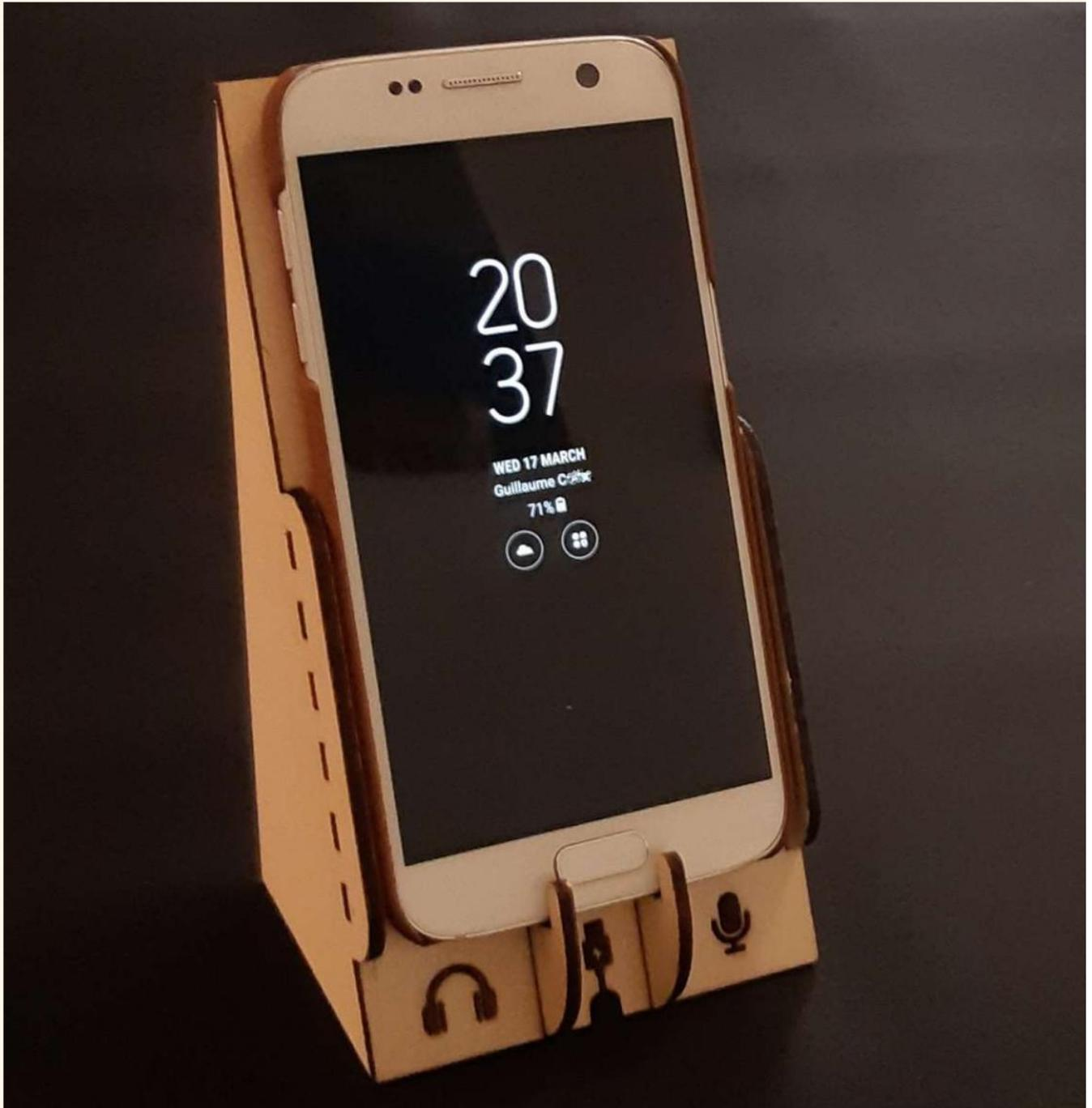
2. **Ajustement des paramètres** : Après avoir choisi les dimensions de base, nous avons paramétré les réglages pour s'adapter au matériau que nous utilisons initialement, à savoir du Plexiglas de 3 mm. Cependant, nous avons rencontré des difficultés avec l'**ajustement des pièces**, car elles ne s'imbriquaient pas correctement. Cela était dû à un coefficient de brûlage trop élevé.
