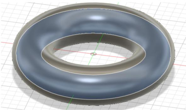
3) Créer un second tore pour obtenir le creux (diamètre intérieur = 85 mm , diamètre du tore = 17 mm).
