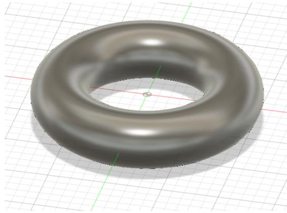
2) Créer un tuyau à l'intérieur du tore (taille de section = 15 mm).
