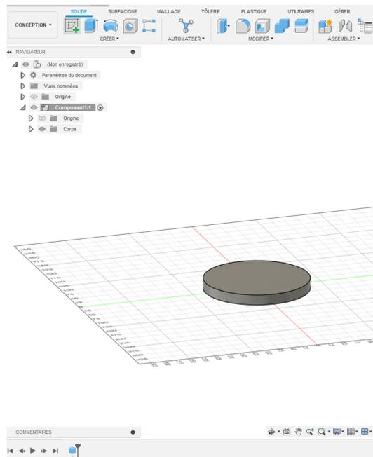
2) Créer l'emplacement de la future bougie dans le cercle (diamètre = 90 mm, profondeur = 10 mm).
