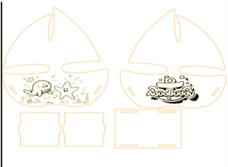
Pour les 2 côtés de la coque, sur un premier côté, nous avons rajouté une ouverture en forme carrée pour pouvoir faire passer le câble Arduino de part et d'autre du bateau, et sur le 2e côté, une fente ronde pour que le fil du capteur à liquide passe.
