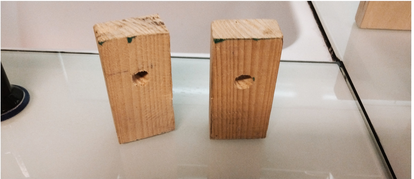
Fig 4: Planches de bois et axes cylindriques avec chutes pour le test moteur
