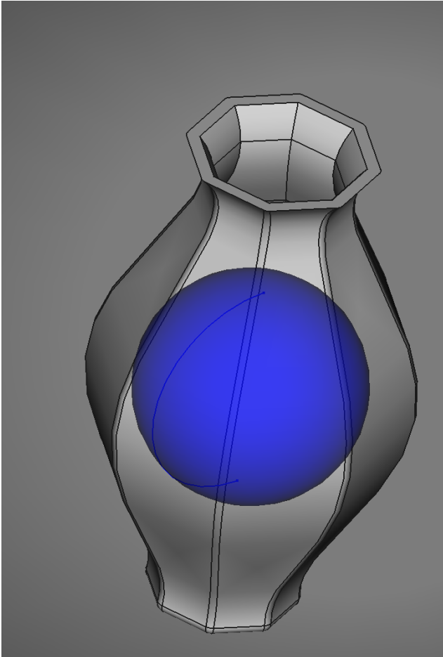
Modèle 3D d'un vase avec boule captive conçu sous FreeCAD
