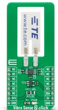
Le but du projet est d'utiliser 3 de ces capteurs pour créer un sismomètre à 3 composantes facile à monter et peu coûteux (Les capteurs coûtent moins de 10euros chacun). Il faudra donc positionner les 3 capteurs selon les 3 axes orthogonaux de l'espace.
