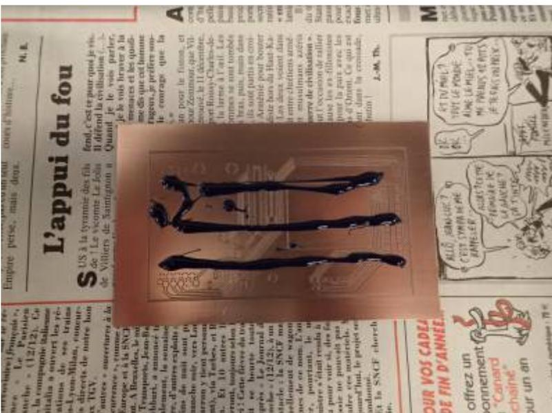
On pose le film transparent sur le PCB et on étale le vernis avec la spatule (ou simplement avec le pouce). Il faut que le vernis parvienne jusqu'au tracé de découpe finale mais il n'est pas nécessaire
