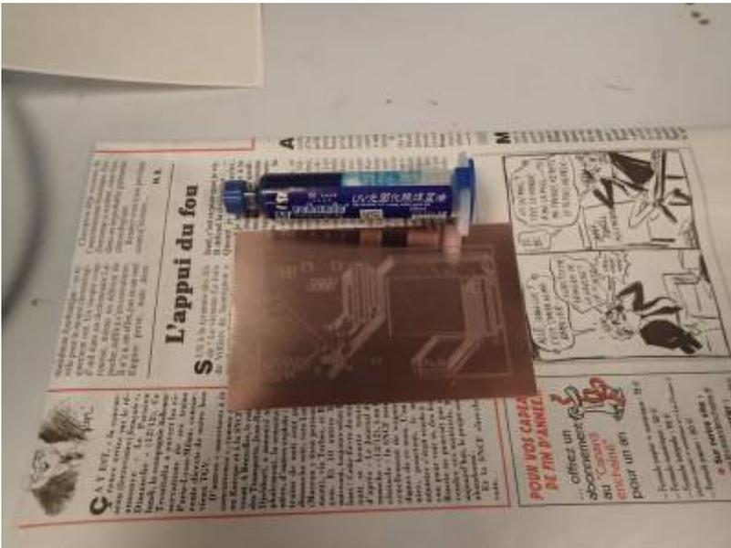
Avant de vernir le PCB il faut le nettoyer très soigneusement, tout d'abord avec une gomme abrasive, puis avec de l'etanol et de l'acétone pour éliminer toute trace d'oxidation, graisse et autre résidus. On peut utiliser de l'air comprimé pour éliminer les particules après chaque étape de nettoyage. Cette étape est primordiale pour que le vernis adhère correctement au PCB, et que les pastilles puissent être facilement soudées ensuite.
