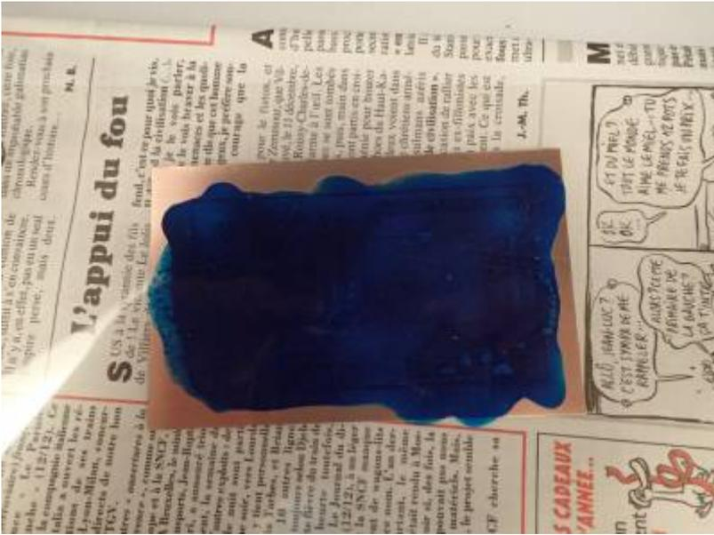
On peut maintenant mettre le PCB dans l'insoleuse (avec le journal et le film transparent pour ne pas polluer la machine avec le vernis !), et insoler 5 à 10 minutes. Il est préférable de laisser le vernis sécher 24h ensuite avant de continuer.
