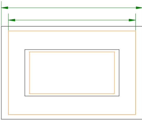
Dans le plan horizontal Une dimension extérieure réelle sera donc:  $L \cdot R + 2 \cdot E_{xy}$ , une dimension intérieure  $l \cdot R - 2 \cdot E_{xy}$ . Si on appelle  $L_m$  et  $l_m$  les dimensions mesurées sur l'éprouvette, on a:
