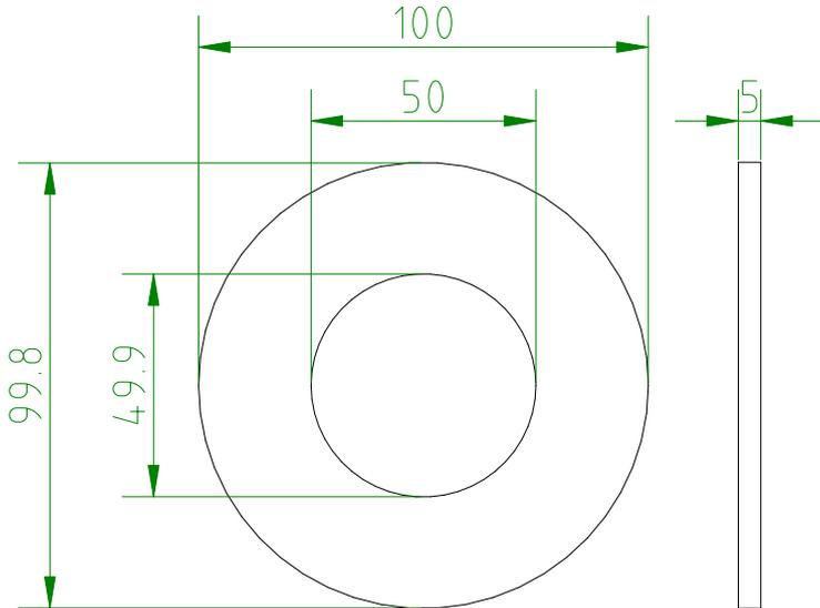
Cela donne un  $R$  de 0,999 et  $E_{xy}$  d'environ 0,1, et un  $E_z$  de 0. Les mesures de l'éprouvette ronde semblent fausses, en particulier les mesures intérieures.
