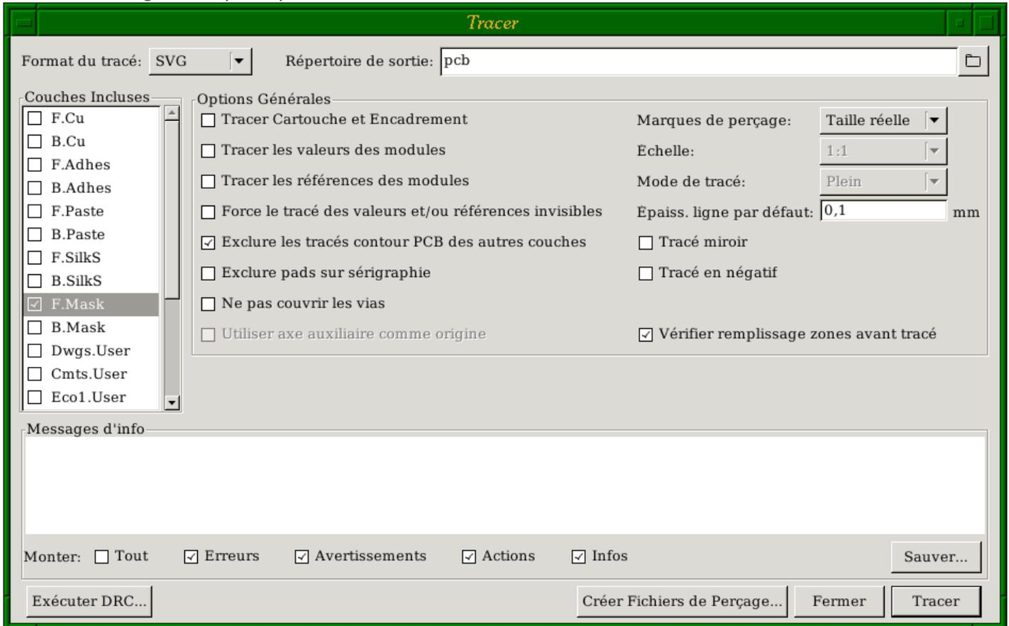
Il faudra ensuite importer ce fichier SVG dans inkscape pour l'envoyer à la Trotec. Dans inkscape sélectionner l'ensemble des pastilles et ajuster les paramètres de couleur: *fill et stroke paint: noir stroke style: 0.01px* (ce qui veut effectivement dire que l'on va faire une gravure et non une découpe, mais les paramètres du laser sont réglés pour traverser le papier).
