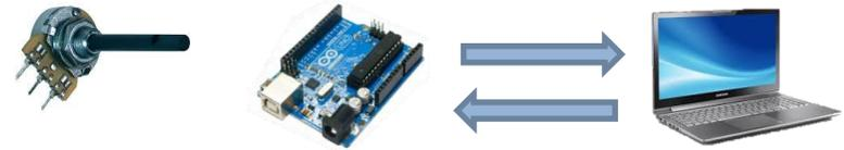
Le potentiomètre est connecté à une entrée analogique de la carte Arduino
