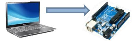
Dans tous les exemples précédents, nous avons utiliser le mode external qui maintient une communication entre le PC et la carte Arduino pour afficher des signaux, modifier des paramètres...
