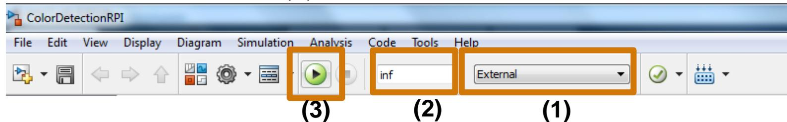
3. Le code C est généré, compilé, téléchargé et exécuté sur la carte. La communication entre la carte et le PC permet de modifier les paramètres du modèle et de visualiser les signaux en temps réel pendant l’exécution.
