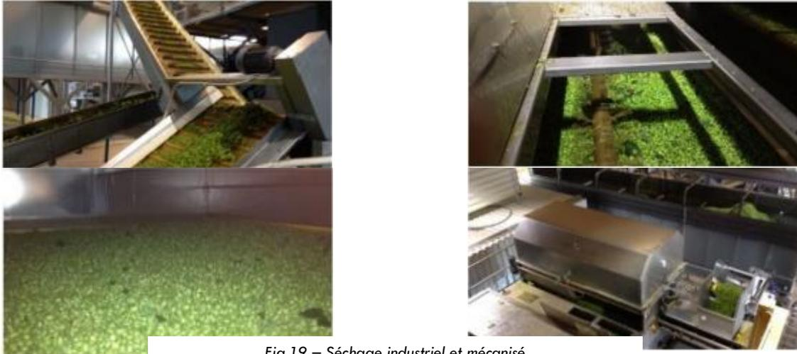
Fig.19 – Séchage industriel et mécanisé
